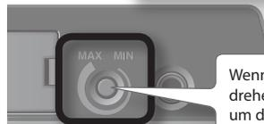
**6-3. Wenn die Display-Beleuchtung rot leuchtet, ist der interne digitale Eingangspiegel zu laut. Drehen Sie den [CTRL 3]-Regler nach links, bis das Display nicht mehr rot beleuchtet ist.**
