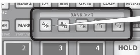
Mit den [A/F]–[E/J]-Tastern können Sie die Sample-Bank wechseln. Um Bank F auszuwählen, drücken Sie den [A/F]-Taster zweimal, sodass er zu blinken beginnt.
