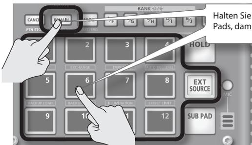
Halten Sie den [REMAIN]-Taster gedrückt, und drücken Sie die gewünschten Pads, damit der Effekt jedem beleuchteten Pad hinzugefügt wird.
