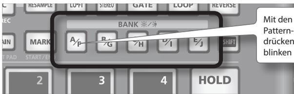
Mit den [A/F]–[E/J]-Tastern können Sie die Pattern-Bank wechseln. Um Bank F auszuwählen, drücken Sie den [A/F]-Taster zweimal, so dass er zu blinken beginnt.
