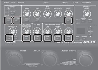
Bei Schritt 1 können Sie jeden der Effekt-Taster drücken, so dass die entsprechende Anzeige entweder blinkt oder leuchtet.
