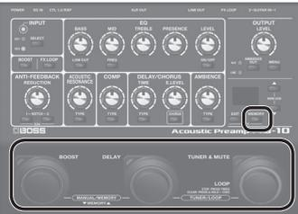
\* Die Stomp Pedal-Einstellungen können für das Pedal vorgenommen werden, dem die Funktion „FX ON/OFF“ zugeordnet ist. Siehe „Zuweisen der Funktionen für die Pedale“ (S. 12).
