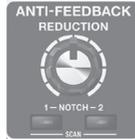
Wenn eine Rückkopplung auftritt, wird die Rückkopplungs-Frequenz automatisch gefiltert und das Pfeifgeräusch eliminiert.
