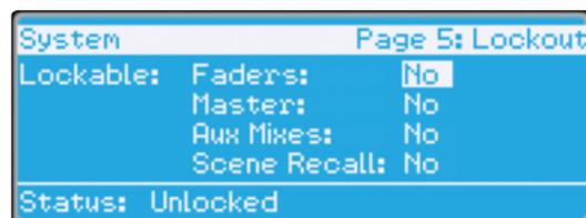
Das StudioLive bietet einen Lockout-Modus, der die Eingabe eines Passworts und das Sperren der Bedienelemente ermöglicht. Das ist besonders dann sinnvoll, wenn mehrere Leute für den Sound verantwortlich zeichnen, jedoch nur ein oder zwei davon in der Lage sind, die Dynamikbearbeitung und dergleichen einzurichten.
