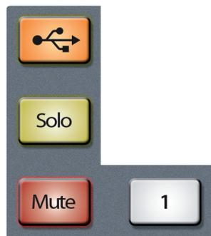
Jeder Kanal und Bus im StudioLive 16.0.2 USB verfügt über eine MultiMode-Taste. Über diese Tasten können Sie einen Kanal oder Aux wahlweise solo oder stummschalten und zudem den USB Return in diesem Kanal aktivieren.
