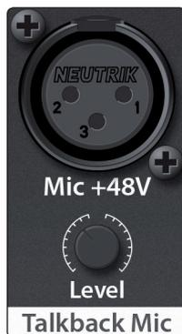
**Talkback-Mic-Eingang und -Regler.** Da das StudioLive kein integriertes Talkback-Mikrofon bietet, müssen Sie für diesen Zweck ein externes Mikrofon anschließen. Bei diesem Mikrofonvorverstärker ist die Phantomspeisung permanent aktiv, sodass Sie sowohl dynamische als auch Kondensatormikrofone verwenden können. Über diesen Regler stellen Sie die Vorverstärkung für den Talkback-Eingang ein.
