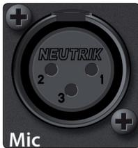
**Mikrofoneingänge.** Ihr StudioLive ist mit 12 PreSonus XMAX Universal-Mikrofonvorverstärkern ausgestattet. Jeder XMAX Vorverstärker besteht aus einer Class A Eingangsstufe gefolgt von einer Dual-Servo-Gain-Stufe. Diese Schaltung ermöglicht eine umfangreiche und extrem rauscharme Vorverstärkung, mit der Sie das Audiosignal ohne unerwünschte Störgeräusche anheben können.
