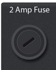
**Sicherung (2 Amp Fuse).** Hinter dieser Kappe befindet sich die Sicherung des StudioLive. Es handelt sich um eine flinke 250 VAC Sicherung mit 2 Ampere, 5 mm x 20 mm.
