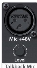
Das StudioLive bietet auf der Rückseite einen Eingang für ein Talkback-Mikrofon. Das Talkback-Mikrofon kann auf die Summe geroutet werden. Beachten Sie, dass die Aux-Ausgänge in dieser Sektion gruppiert sind. Wenn Sie Aux 3 beispielsweise für die Monitormischung für den Bodenmonitor des Bassisten und Aux 4 als In-Ear-Send für den Keyboarder verwenden, wird das Talkback-Signal auf beide Monitorwege gespeist: Sagen Sie also nichts, was einer der beiden eventuell nicht hören sollte!
