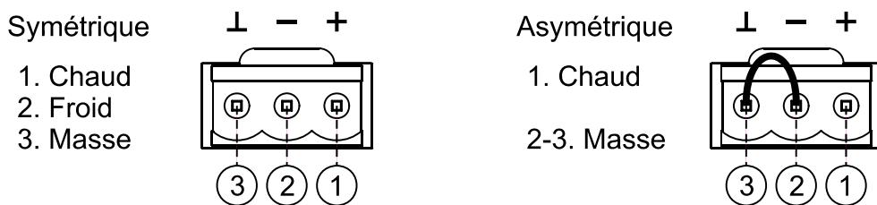
Pour utiliser la sortie en mode symétrique, il faut court-circuiter les broches 2 et 3, comme indiqué dans le schéma précédent. Sinon, le signal de sortie n'aura pas le niveau ni la qualité adéquats.
