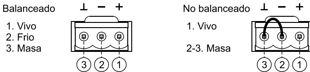
En caso de querer usar la salida en modo balanceado es preciso cortocircuitar los terminales 2 y 3, tal y como indica el diagrama anterior. De no hacerlo así la señal de salida no tendrá el nivel ni la calidad adecuados.
