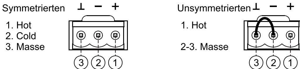
Soll der Ausgang symmetrisch genutzt werden, so müssen die Anschlüsse 2 und 3, wie im vorigen Diagramm gezeigt, kurzgeschlossen werden. Geschieht dies nicht, so hat das ausgehende Signal weder den geeigneten Pegel noch die geeignete Qualität.
