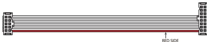
1. Stecken Sie den 16-pin-Anschluss des Eurorack-Netzkabels in den Eurorack-Stromanschluss, so dass sich das rote Kabel in einer Linie mit dem -12 V-Pin befindet.
