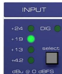
Nach Anwahl von **DIG** erscheint das digitale Eingangssignal an den digitalen Ausgängen, die AD-Wandlung ist dann deaktiviert. Die Level Meter zeigen nun die Pegel des digitalen Eingangssignales an.
