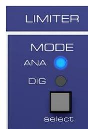
Zur Verringerung des unvermeidlichen Klirrfaktors eines Peak-Limiters (Nichtlinearität der Regelemente und Erzeugung des Regelsignals) trägt sowohl der vollsymmetrische Schaltungsaufbau, als auch die digital kontrollierte Releasezeit bei. Der Klirrfaktor von circa 0,3% bleibt daher bei jedem Pegel und jeder Frequenz gleich.
