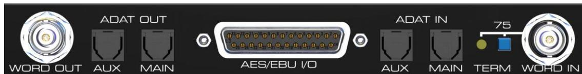
**WORD IN** (BNC): Über den versenkten Druckschalter kann der Eingang intern mit 75 Ohm terminiert werden.
