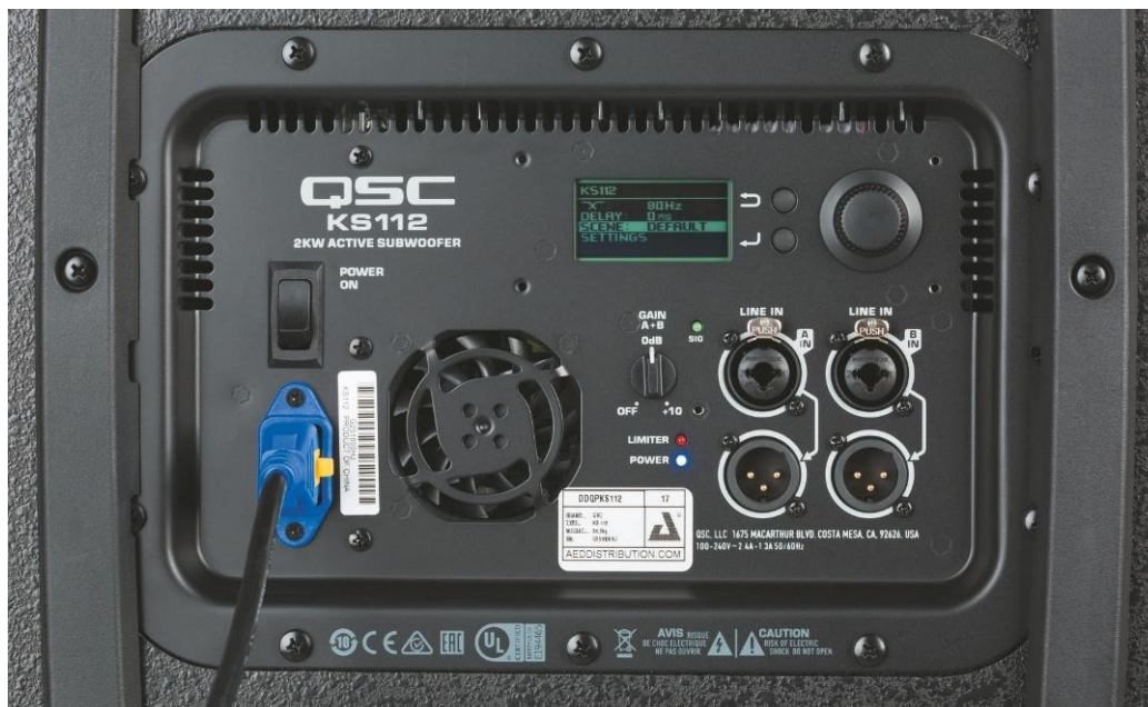
Elektronikmodul im Subwoofer QSC KS112
