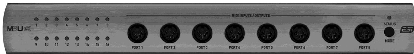
Von links nach rechts beinhaltet die Vorderseite 16 LEDs, die jeweils grün (d.h. der entsprechende Port ist ein Eingang) oder rot (d.h. der entsprechende Port ist ein Ausgang) leuchten. Daneben sind die MIDI-Anschlüsse Nummer 1 bis 8. Rechts davon ist der **MODE** Schalter zur Steuerung des Standalone-Betriebs (siehe unten) und darüber ist das **STATUS** LED, welches rot leuchtet, wenn das Gerät standalone verwendet wird und grün, wenn es per USB am Computer betrieben wird.
