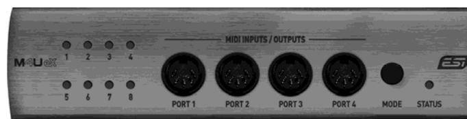
Von links nach rechts beinhaltet die Vorderseite 8 LEDs, die jeweils grün (d.h. der entsprechende Port ist ein Eingang) oder rot (d.h. der entsprechende Port ist ein Ausgang) leuchten. Daneben sind die MIDI-Anschlüsse Nummer 1 bis 4. Rechts davon ist der **MODE** Schalter zur Steuerung des Standalone-Betriebs (siehe unten) und rechts daneben ist das **STATUS** LED, welches rot leuchtet, wenn das Gerät standalone verwendet wird und grün, wenn es per USB am Computer betrieben wird.
