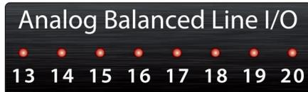
**Signalanzeigen.** Mit diesen 32 Anzeigen lassen sich wahlweise die Analog-Ein- oder -Ausgänge überwachen – den gewünschten Modus stellen Sie über UC Surface ein. *Weitere Informationen finden Sie in Abschnitt 4.2.*
