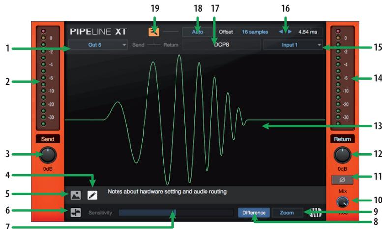
1. **Send (Ausgang).** Über dieses Dropdown-Menü wählen Sie den physikalischen Ausgang des Quantum 4848, den Sie zum Anschluss Ihres externen Geräts nutzen möchten. *Hinweis: Monophone Instanzen von Pipeline XT können nur mit monophonen Ausgangsbussen genutzt werden. Stereophone Instanzen von Pipeline XT können sowohl mit mono- als auch stereophonen Ausgangsbussen verbunden werden.*
