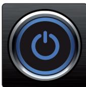
**Power-Taste und Sync-Leuchte.** Der beleuchtete Ring um die Power-Taste Ihres Quantum 4848 dient als Anzeige der Clock-Quelle / Synchronisation. Er zeigt an, ob Ihr Gerät ein gültiges Clock-Signal empfängt.
