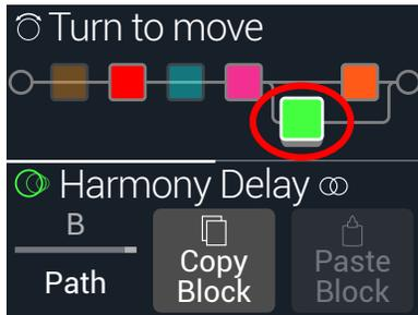
3. Drehen Sie am oberen Regler, um den Block zu verschieben.
