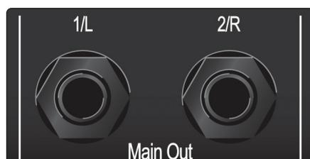
**Main-Ausgänge.** Das sind die Hauptsummenausgänge für Ihr Studio 24c. Der Ausgangspegel für die Main-Ausgänge wird über den Main-Pegelsteller auf der Gerätevorderseite eingestellt. Die Wiedergabe-Streams 1 und 2 werden auf diese Ausgänge geroutet.
