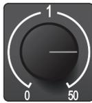
**Eingangspegelregler.** Diese Regler bieten eine variable Verstärkung von 50 dB (0 bis +50 dB für Mikrofone, -15 bis 35 dB für Line-/Instrumentensignale).
