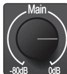
**Main.** Der Main-Regler steuert den Ausgangspegel für die Main-Ausgänge Links/Rechts auf der Rückseite des Studio 24c im Bereich von -80 dB bis 0 dB. Dieser Regler hat einen rein dämpfenden Effekt.
