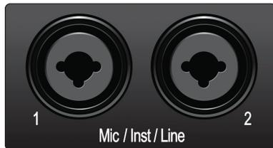
**Mikrofoneingänge.** Ihr Studio 24cInterface ist mit hochwertigen Mikrofonvorverstärkern für jeden beliebigen Mikrofontypus ausgestattet. Das Studio 24c bietet speziell für die Stromversorgung über den USB-Bus optimierte XMAX-L Solid State Mikrofon-Preamps.
