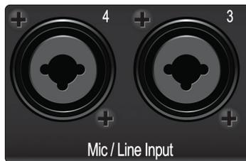
**Mic/Line-Eingänge (Studio 68c).** Diese Combo-Eingangsbuchsen für Mikrofon/Line sind für den Anschluss von Mikrofonen (XLR) und Linepegel-Quellen (6,35 mm TRS-Klinke) ausgelegt.
