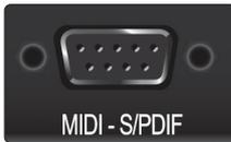
**Anschluss für MIDI-/S/SPDIF-Kabelpeitsche (Studio 68c).** Schließen Sie hier die Kabelpeitsche mit den MIDI- und S/SPDIF-Anschlüssen an.
