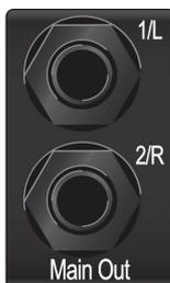
**Main-Ausgänge.** Das sind die Hauptsummenausgänge für Ihr Studio-Series Interface. Der Ausgangspegel für die Main-Ausgänge wird über den Main-Pegelsteller auf der Gerätevorderseite eingestellt. Die Wiedergabe-Streams 1 und 2 werden auf diese Ausgänge geroutet.
