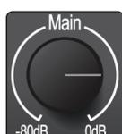
**Main.** Der Main-Regler steuert den Ausgangspegel für die Main-Ausgänge Links/Rechts auf der Rückseite des Studio-Series Interfaces im Bereich von -80 dB bis 0 dB. Dieser Regler hat einen rein dämpfenden Effekt.
