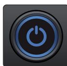
**Power-Taste und Sync-Leuchte (nur Studio 1824c).** Der beleuchtete Ring um die Power-Taste Ihres Studio 1824c dient als Anzeige der Clock-Quelle. Er zeigt an, ob Ihr Gerät ein gültiges Clock-Signal empfängt.
