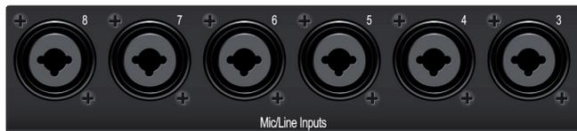
**Mic/Line-Eingänge (nur Studio 1824c).** Die Combo-Anschlüsse auf der Rückseite des Studio 1824c können wahlweise für Mikrofone oder Line-Geräte verwendet werden. Die XLR-Anschlüsse sind für Mikrofone und DI-Boxen ausgelegt, die 6,35 mm TRS-Eingänge für Line-Signale bis +18 dBFS. Über die Trim-Regler auf der Vorderseite wird die Vorverstärkung für beide Signaltypen gesteuert.
