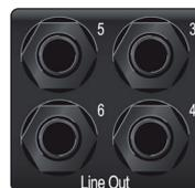
**Line-Ausgänge.** Über diese symmetrischen 6,35 mm TRS-Line-Ausgänge lassen sich externe Geräte wie Kopfhörerverstärker, Signalprozessoren und zusätzliche Monitore ansteuern. Studio 1824c: Die ersten zwei Ausgänge führen dasselbe Wiedergabesignal wie die Hauptausgänge und der Kopfhörerausgang 1. Die Ausgänge 3 und 4 führen im
