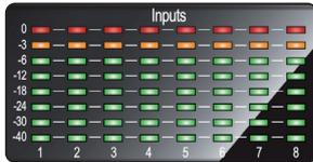
**Eingangspegelanzeigen.** Diese LED-Pegelanzeigen stellen den Pegel an den analogen Eingängen Ihres Studio-Series Interfaces dar. Die roten Clip-LEDs leuchten auf, sobald der Pegel am Eingang -0,5 dBFS überschreitet. Ab diesem Pegel kommt es zu einer Übersteuerung der AD-Wandler mit hörbaren Verzerrungen. Verwenden Sie die Gain-Steuerung, um die Pegel unterhalb dieser Grenze zu halten.
