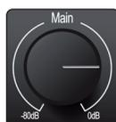
**Main.** Der Main-Regler steuert den Ausgangspegel für die Main-Ausgänge Links/Rechts auf der Rückseite des Studio-Series Interfaces im Bereich von -80 dB bis 0 dB. Dieser Regler hat einen rein dämpfenden Effekt.
