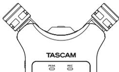
In dieser Position sind die Mikrofone weit voneinander entfernt und nehmen dadurch einen breiten Stereobereich auf. Dies ist eine gute Einstellung für Musik oder andere Ereignisse, bei denen eine räumliche Abbildung der Schallquelle(n) erwünscht ist.
