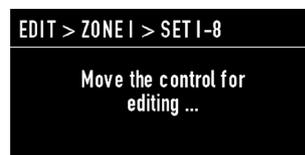
Betätigen Sie das gewünschte physische Steuerelement, das Sie programmieren möchten (drücken Sie einen Taster, drehen Sie an einem Regler oder betätigen Sie einen Schieberegler).
