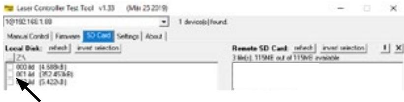
Klicken Sie auf die Schaltfläche mit den beiden Pfeilen nach rechts, um die \*.ild-Dateien auf die integrierte SD-Karte hochzuladen. Die Dateien werden kopiert und gespeichert. **Beachten Sie, dass der Upload von ILDA-Dateien aufgrund der optimierten Datenstruktur auf dem Mainboard einige Zeit dauern kann (mehrere Minuten)!**
