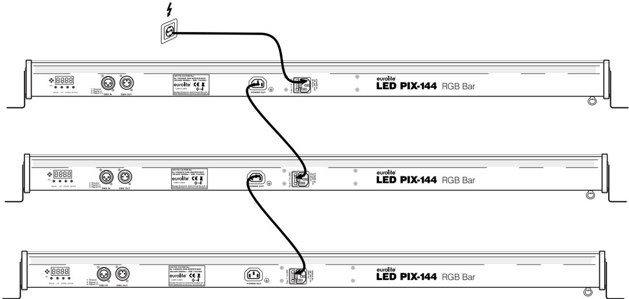
Das Gerät verfügt über ein Schaltnetzteil, das eine Netzspannung zwischen 100 und 240 Volt erlaubt.
