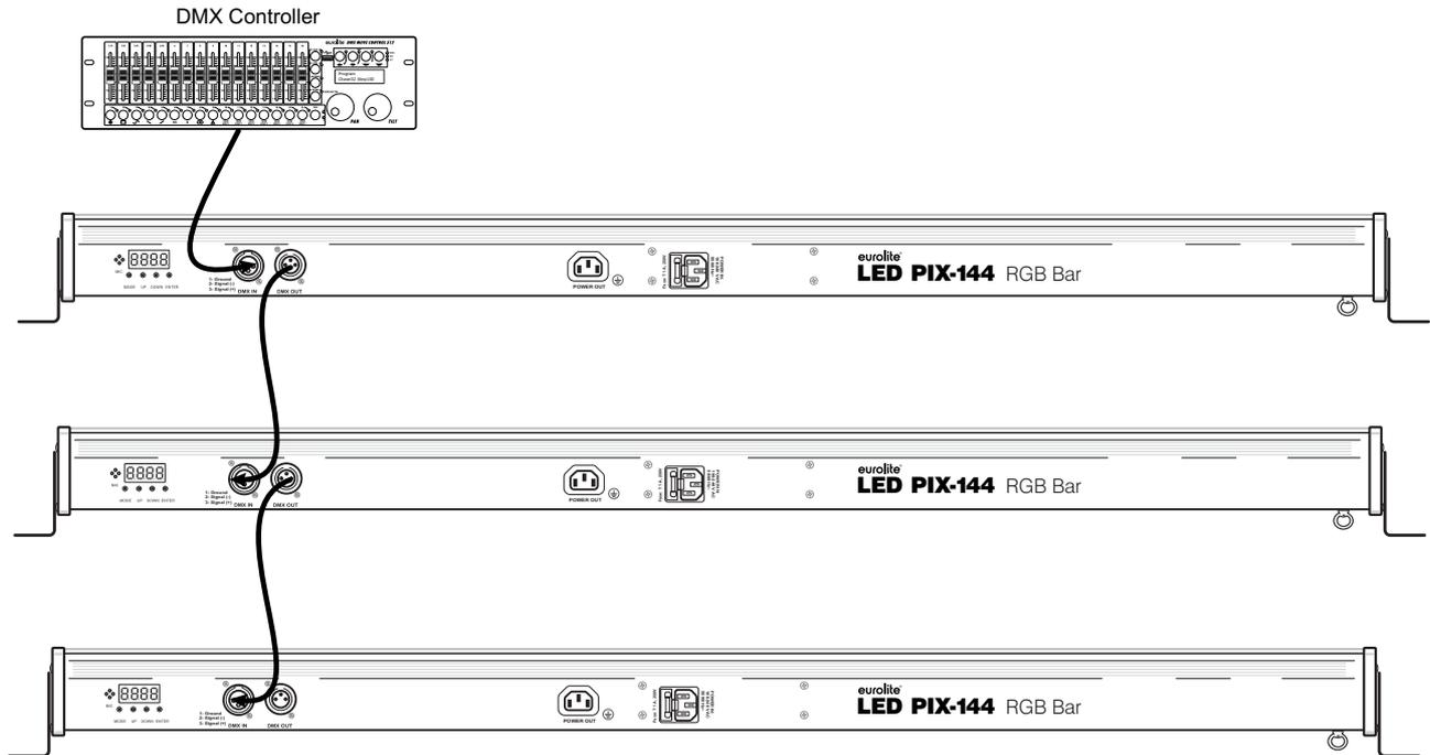
Für die Ansteuerung des Geräts per DMX512 ist eine Datenverbindung notwendig. Das Gerät verfügt dazu über 3-polige XLR-Anschlüsse.
