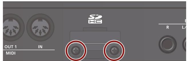
2. Nehmen Sie die im Instrument eingesetzte SD-Karte heraus und setzen Sie die neue SD-Karte ein.
