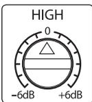
**High:** Verstärkt oder dämpft alle Frequenzen oberhalb von 10 kHz um  $\pm 6$  dB.
