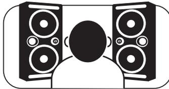
Die Eris E44 und E66 können vertikal oder horizontal aufgestellt werden. In der vertikalen Ausrichtung sollten sie jedoch spiegelverkehrt ausgerichtet werden, sodass die Hochtöner jeweils auf der Außenseite liegen.
