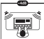
Wenn die Monitore in der Nähe einer Raumecke aufgestellt werden, stellen Sie den Schalter Acoustic Space zunächst auf -4 dB, was für eine maximale Bassdämpfung sorgt.
