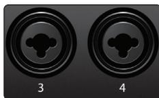
**Mikrofon-/Line-Eingänge.** Die 6,35 mm TRS-Buchsen der Kanäle 3 bis 8 sind für den Anschluss von Linepegel-Quellen (Synths, Keyboards, Effektprozessoren etc.) vorgesehen. Wenn Sie ein Gerät am Line-Eingang anschließen, wird der Mikrofonvorverstärker umgangen und das Signal direkt auf die Instrumenten-Vorverstärkerstufe gespeist.
