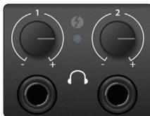
**Sync-Anzeige.** Diese LED zeigt den Status der Clock-Quelle/-Synchronisation an. Sie zeigt an, ob Ihr Gerät ein gültiges Clock-Signal empfängt.
