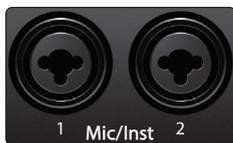
**Mikrofon-/Instrumenteneingänge.** Die 6,35 mm TS-Buchsen für die Kanäle 1 und 2 sind für den Anschluss von Instrumenten (Gitarre, Bass etc.) ausgelegt. Wenn Sie ein Instrument am Instrumenteneingang anschließen, wird der Mikrofonvorverstärker umgangen und das Signal direkt auf die Instrumenten-Vorverstärkerstufe gespeist.
