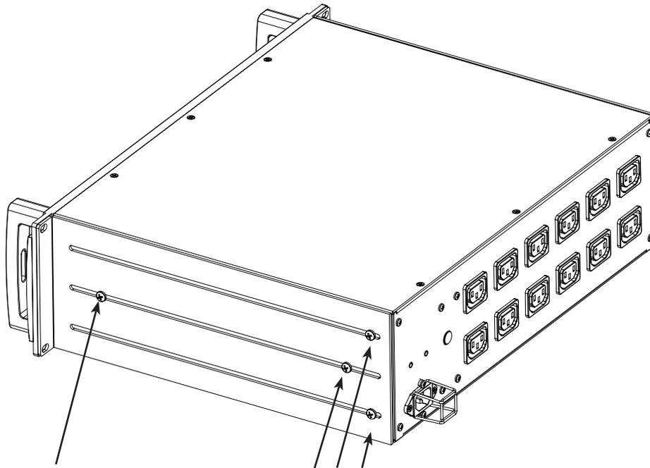
Lösen Sie einfach die Sicherungsschrauben an den Seiten und an der Vorderseite des hinteren Rack-Ear und der Verstärkungsplatte an beiden Gehäuseseiten des P-2300 IT E.
