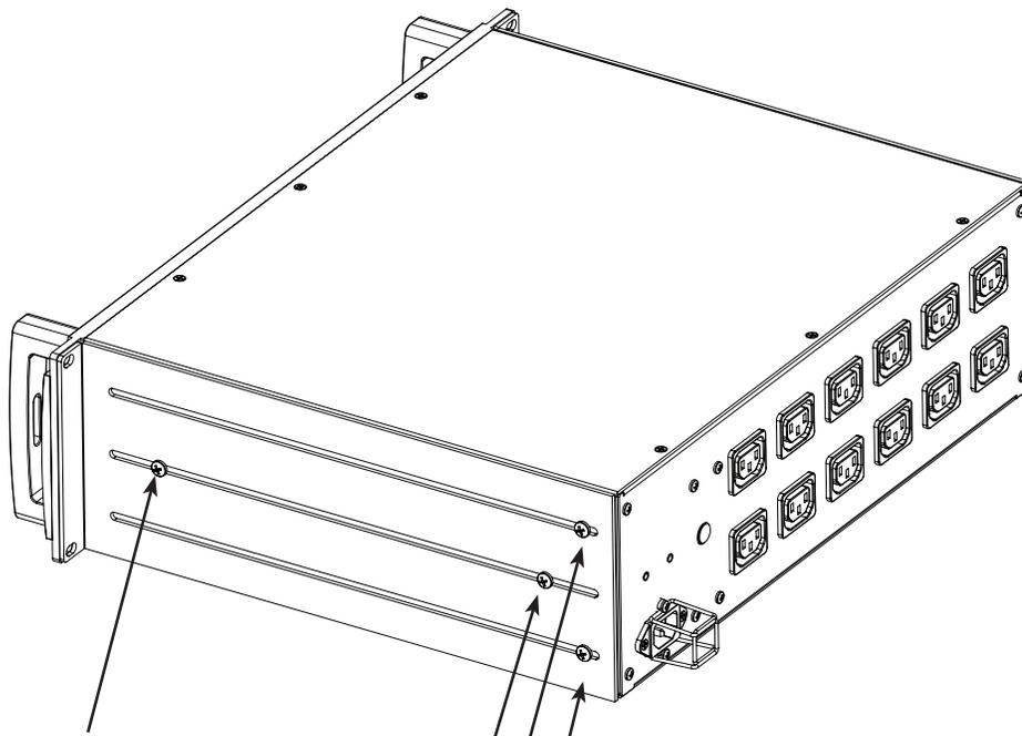
Simplemente quite los tornillos de seguridad de las porciones frontal y lateral de la muesca del estante posterior ajustable y la placa lateral de refuerzo (ubicados en cualquiera de los lados del chasis). inviértalos y vuelva a adjuntarlos al chasis del P-2300 IT E. (Vea la Figura 1.a, página 32)
