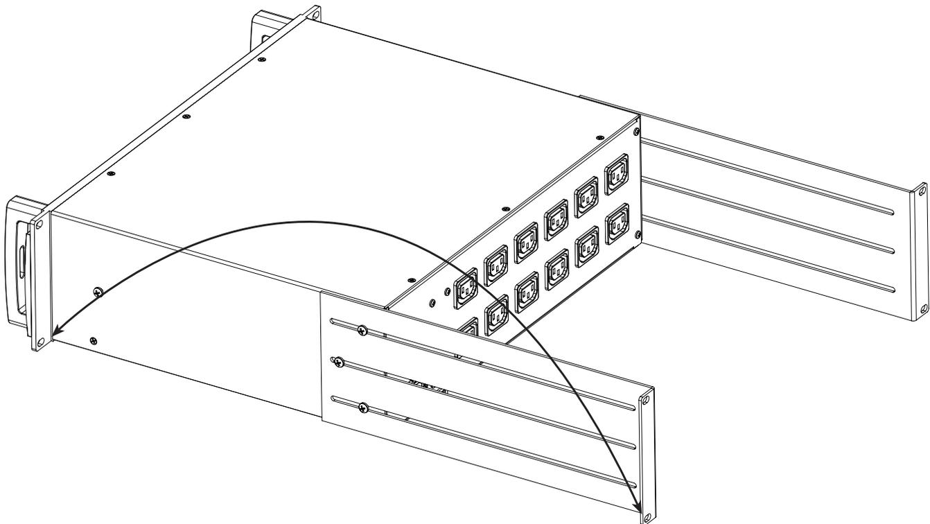
Drehen Sie diese um und befestigen Sie diese am Gehäuse des P-2300 IT E (zoals hier getoond).
