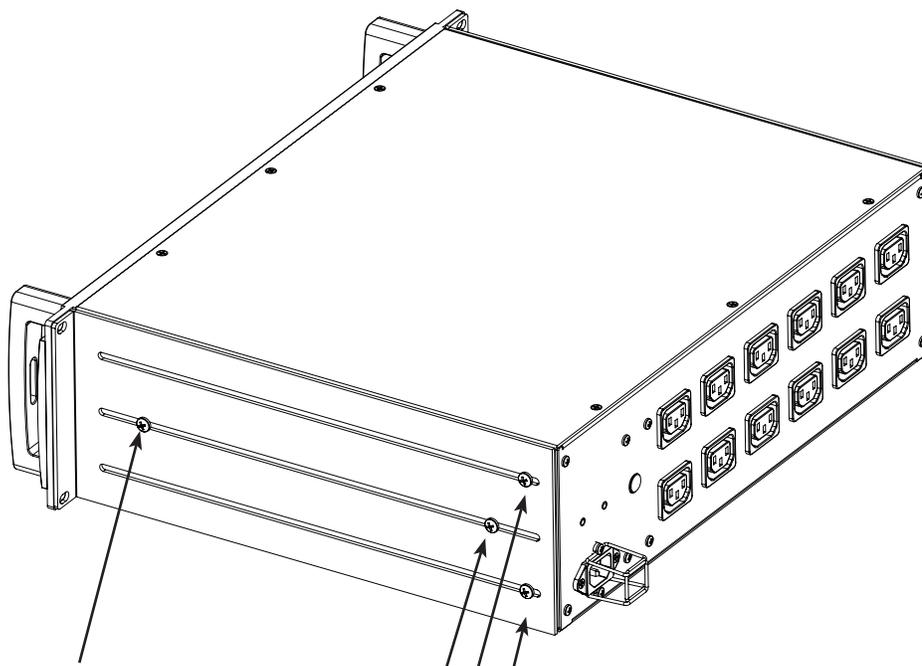
Retirez simplement les vis de montage des parties avant et latérales du bâti réglable à l'arrière du P-2300 IT E et la plaque latérale de renfort (située d'un côté ou de l'autre du châssis).
