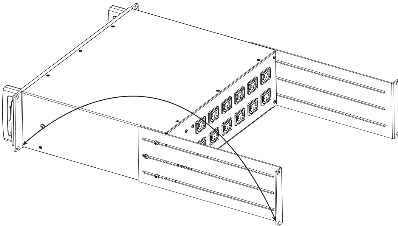
Inversez-la et réassemblez-la sur le châssis du P-2300 IT E (comme montré ici).
