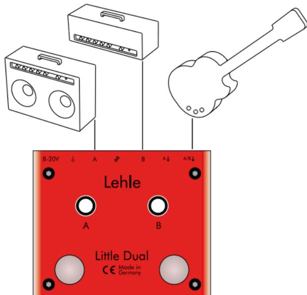
Der **Lehle Little Dual** wurde speziell dafür entwickelt, ein Instrumentensignal brummfrei und ohne Verluste auf zwei Amps zu verteilen, die gleichzeitig in Betrieb sind. Dadurch lassen
