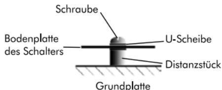
Der **Lehle Little Dual** lässt sich aufgrund einer bereits vorgefertigten Befestigungsvorrichtung problemlos auf einer Grundplatte montieren. Öffnen Sie dazu die vier Gehäuseschrauben des Deckels und ziehen Sie den Deckel ab. Befestigen Sie
