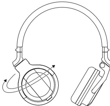
Dieses Produkt ist mit einem Drehmechanismus ausgestattet, der verschiedene Arten des Mithörens ermöglicht. Überprüfen Sie vor der Verwendung des Produkts dessen Betriebsrichtung. Wenn Sie den Kopfhörer gewaltsam in eine ungeeignete Richtung drehen, kann das Produkt beschädigt werden.
