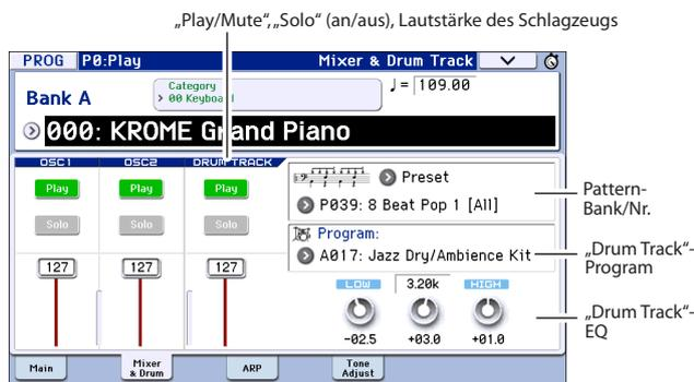
2. Wählen Sie ein „Drum Track“-Pattern. Wählen Sie mit „Pattern Bank“ die „Preset“- oder „User“-Bank und mit „Pattern No.“ das gewünschte Pattern.
