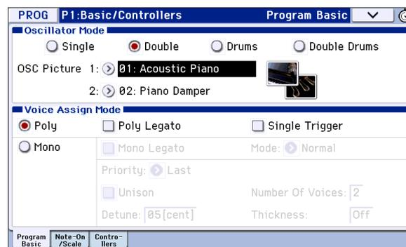
Im „Single“-Modus wird nur ein Oszillator, im „Double“-Modus dagegen zwei verwendet.
