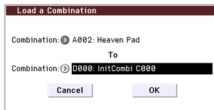
3. Wählen Sie über „Combination“ (obere Zeile) die zu ladende Combination und geben Sie mit „(To) Combination“ (untere Zeile) den internen Zielspeicher an. Wählen Sie hier „D000“.
