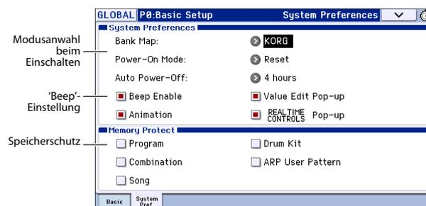
1. **Wechseln Sie zur Seite „P0: Basic Setup– System Preferences“ im Global-Modus.**
