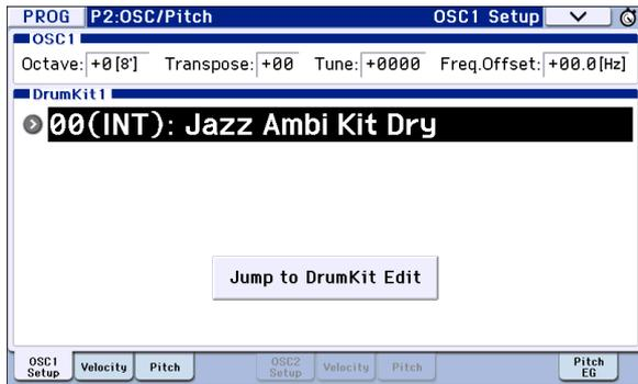
4. Stellen Sie die Basistönhöhe des Oszillators ein. Für Drumkits muss „Octave“ prinzipiell auf „+0 [8]“ gestellt werden.
