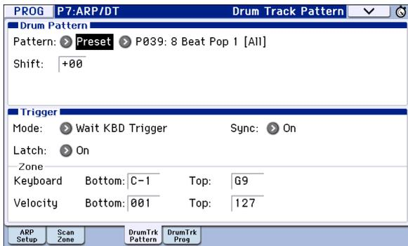
2. Wählen Sie mit „Trigger Mode“, wie das „Drum Track“-Pattern gestartet und gestoppt werden soll.
