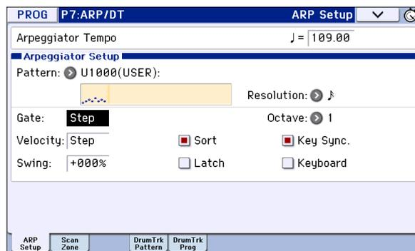
Wenn Sie „Gate“, „Velocity“ und „Swing“ editieren möchten, müssen Sie den SELECT-Taster auf „ARP“ und Regler 1 (GATE) sowie 2 (VELOCITY) in die Mitte („12 Uhr“) stellen.
