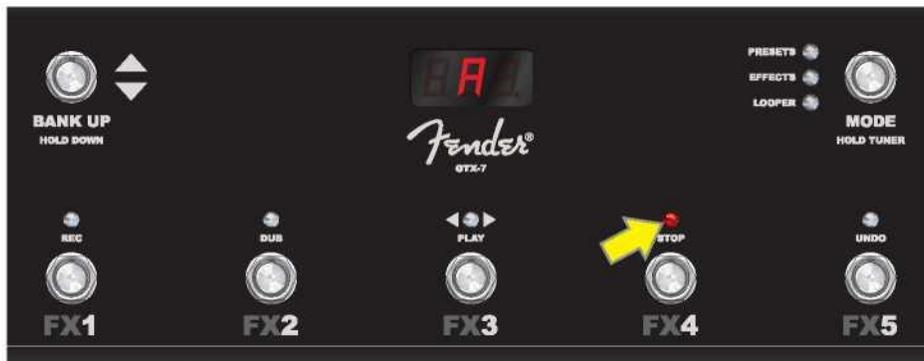
In einem weiteren Beispiel leuchtet die FUNKTIONS-LED 4 (gelber Pfeil). Dies bedeutet, dass die zu stimmende Note „A“ leicht überstimmt ist..
