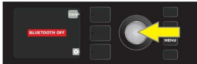
Die Standardeinstellung für Bluetooth ist „off“, also Aus (rot hervorgehoben). Drücken Sie den ENCODER, um die Bluetooth-Funktion einzuschalten (grün hervorgehoben).
