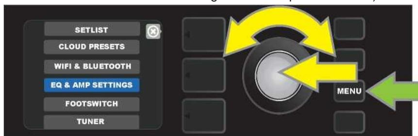
Um auf die Global EQ-Funktion zuzugreifen, drücken Sie zuerst die MENU-Taste und verwenden Sie den ENCODER, um zu „EQ & Amp Settings“ zu scrollen und diese Option auszuwählen..
