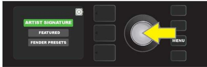
Nachdem Sie eine Cloud-Preset-Kategorie durch Drücken des ENCODERS ausgewählt haben, scrollen Sie durch die Liste der angezeigten Voreinstellungen (gelber Pfeil in der Abbildung unten). Eine Vorschau des markierten Presets wird automatisch abgespielt. Um dem Verstärker ein markiertes Preset hinzuzufügen, drücken Sie die SAVE-Taste (grüner Pfeil).
