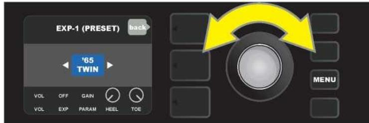
In den EXP-1 PRESET SETTINGS (Voreinstellungs-Optionen) werden der Verstärker und die Effekte in einem Preset, dem der EXP-1 zugewiesen werden kann, nacheinander in der SIGNALPFAD-EBENE angezeigt. Verwenden Sie den ENCODER, um durch die Liste zu scrollen. Im obigen Beispiel ist ein 65er Twin Amp markiert
