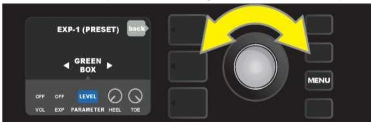
Scrollen Sie mit dem ENCODER (gelber Pfeil) zu „PARAMETER“. Diese Option enthält die einzelnen Steuerelemente für den in der SIGNALPFAD-EBENE hervorgehobenen Effekt. In dem hier gezeigten Beispiel ist „LEVEL“ einer der Green Box-Overdrive-Parameter, die dem EXP-1-Pedal zugewiesen werden können.
