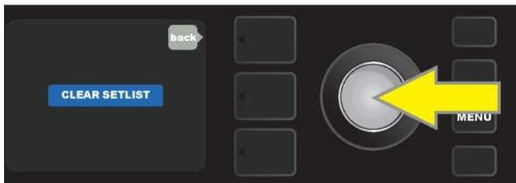
Um ein einzelnes Preset aus einer Setlist zu löschen, markieren Sie das zu löschende Preset, indem Sie mit dem ENCODER dorthin scrollen. Drücken Sie die REGLER-EBENEN-Taste, direkt neben dem Zahnradsymbol in der ANZEIGE:
