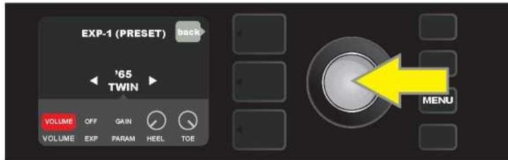
Drücken Sie den ENCODER, wenn die Markierung auf "VOLUME" steht. Das Beschriftungsfeld wechselt von blau zu rot, um anzudeuten, dass jetzt eine Anpassung vorgenommen werden kann.
