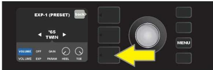
Drücken Sie in diesem Beispiel die REGLER-EBENEN-Taste, um die Pedalfunktion Lautstärkemodus des EXP-1- für den in der SIGNALPFAD-EBENE gezeigten '65 Twin auszuschalten. Der „VOLUME“ -Modus wird in der REGLER-EBENE automatisch hervorgehoben.
