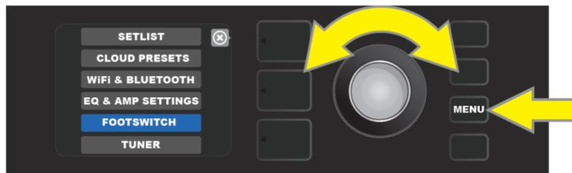
Verwenden Sie den ENCODER, um unter den im Menü angezeigten Geräten die Option „GTX-7 (7-BUTTON)“ auszuwählen. Verwenden Sie dann den ENCODER, um im nächsten Schritt „FX ASSIGN“ auszuwählen:
