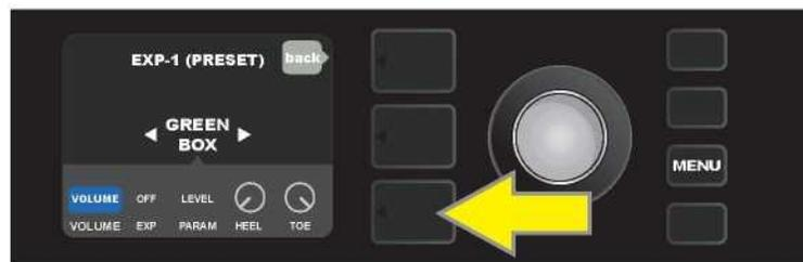
Um das EXP-1-Pedal einem bestimmten Effekt innerhalb eines Presets zuzuweisen, drücken Sie die REGLER-EBENEN-Taste (gelber Pfeil), um auf diverse Elemente, einschließlich der Parametereinstellungen („PARAM“) für den Effekt zuzugreifen. In dem hier gezeigten Beispiel steuert das EXP-1 einen Green-Box-Overdrive-Stompbox-Effekt.
