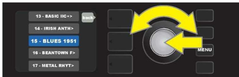
Um ein Preset aus der Preset-Liste zu löschen, drücken Sie die MENU-Taste, scrollen Sie mit dem ENCODER zu „EQ & AMP SETTINGS“ und wählen Sie „PRESET ORGANIZER“, wie auf der vorherigen Seite beschrieben. Verwenden Sie dann den ENCODER, um zu „CLEAR PRESET“ zu scrollen und die Option auszuwählen. (siehe folgende Abbildung).
