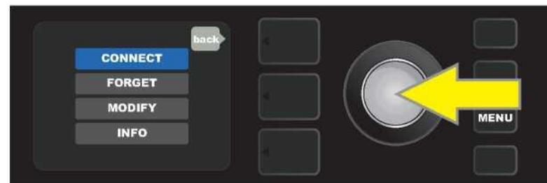
Wählen Sie nach Auswahl eines Netzwerks „CONNECT“ aus dem angezeigten Menü, indem Sie den ENCODER drücken (weitere Optionen in diesem Menü finden Sie auf Seite 37).
