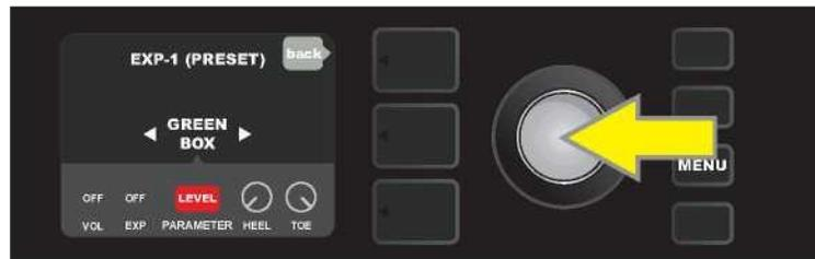
Drücken Sie im obigen Beispiel den ENCODER (gelber Pfeil), wenn die Markierung auf „LEVEL“ steht. Die Feldfarbe wechselt von blau zu rot, um anzuzeigen, dass dann Anpassungen an diesem Parameter des Green-Box-Overdrive-Effekts für die Verwendung mit dem EXP-1-Pedal vorgenommen werden können.
