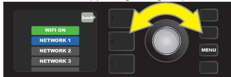
Sobald das WLAN aktiviert wurde (grün hervorgehoben), scrollen Sie mit dem ENCODER durch die verfügbaren Netzwerke. Wählen Sie ein blau markiertes Netzwerk aus, indem Sie den ENCODER drücken.
