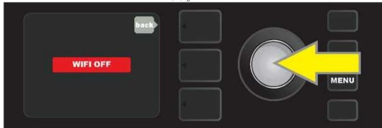
Die Standardeinstellung für WLAN ist "Aus" (rotes Feld, mit off gekennzeichnet). Drücken Sie den ENCODER, um das WLAN einzuschalten (Option wird grün hervorgehoben).
