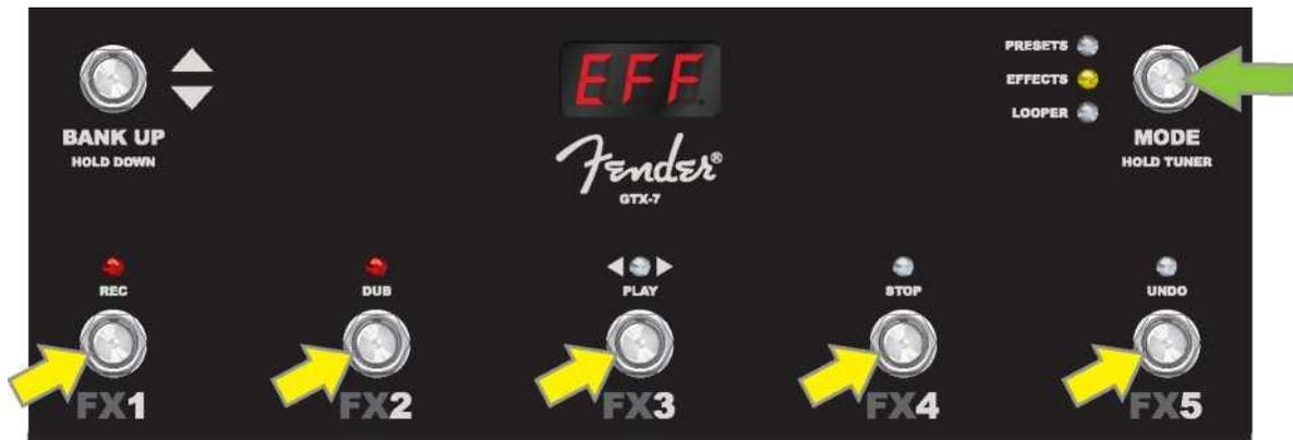
Beispiel für die Verwendung des EFFEKT-Modus mit einem Preset mit zwei Effekten, die jeweils den Funktionstasten FX1 und FX2 zugewiesen sind. Die rot leuchtenden FUNKTIONS-LEDs über FX1 und FX2 zeigen an, dass beide Effekte aktiv sind. Beide können durch Betätigen der jeweiligen Funktionstasten ausgeschaltet werden.
