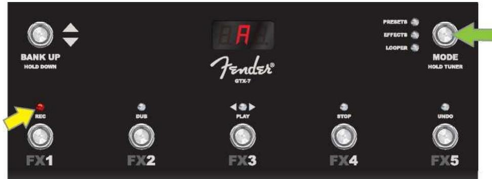
Um die Stimmgeräte-Funktion des GTX-7-Fußschalters zu aktivieren, halten Sie die MODE-Taste (grüner Pfeil) gedrückt. In dem hier gezeigten Beispiel ist eine A-Note sehr unterstimmt, wie durch das Leuchten der FUNKTIONS-LED 1 ganz links (gelber Pfeil) angezeigt wird.
