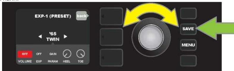
Drehen Sie den ENCODER (gelber Pfeil) auf die Position „OFF“ und drücken Sie ihn, um die Einstellung „OFF“ auszuwählen. Die Pedalfunktion Lautstärkemodus des EXP-1 des in der SIGNALPFAD-EBENE gezeigten Verstärkers ist jetzt ausgeschaltet, und die Feldfarbe wird wieder blau. Drücken Sie die SAVE-Taste (grüner Pfeil), um die Änderungen beizubehalten.
