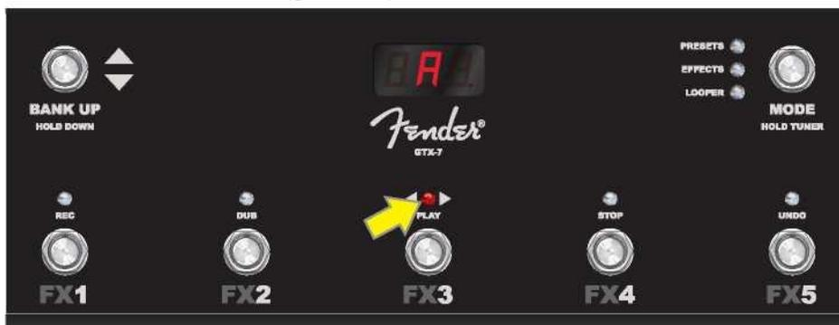
Hier befindet sich die Note „A“ in der richtigen Tonhöhe, was durch das Aufleuchten der FUNKTIONS-LED 3 in der Mitte (gelber Pfeil) angezeigt wird. Wenn Sie mit dem Stimmen fertig sind, drücken Sie eine beliebige Taste, um den Stimmgeräte-Modus des Fußschalters zu beenden.
