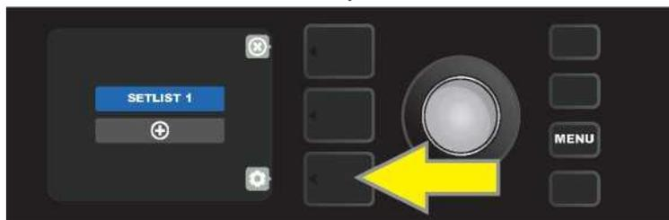
"CLEAR SETLIST" erscheint in einem blauen Feld; Drücken Sie den ENCODER nun, um alle Presets in dieser Setlist zu löschen. Drücken Sie alternativ die obere EBENEN-Taste, direkt neben „back“ im ANZEIGEFENSTER, um zum vorherigen Menü zurückzukehren, ohne die Setlist zu löschen:
