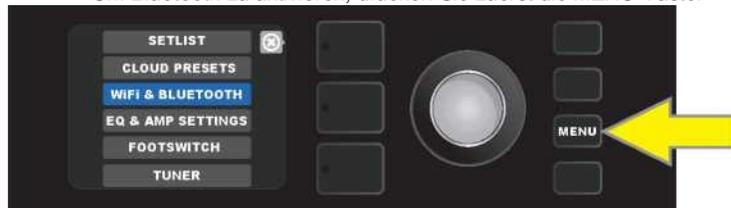
Scrollen Sie mit dem ENCODER durch das Menü zu „WIFI & BLUETOOTH“ und drücken Sie dann den ENCODER auf „BLUETOOTH“.
