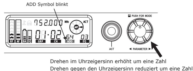
1. Drücken Sie den Drehregler um die Funktionsauswahl zu aktivieren. Jedes Mal wenn der Drehregler gedrückt wird, bewegt sich der Cursor im Display eine Funktion weiter.
