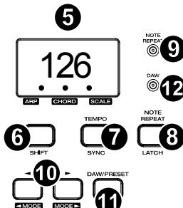
11. **DAW/PRESET:** Wenn diese Taste gedrückt wird, wird die Preset oder DAW-Funktionalität der Tastatur für Fader, Regler, Tasten und Pads aktiviert.
