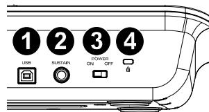
**Hinweis:** Die Polarität des Sustain-Pedals wird automatisch ermittelt, sobald Oxygen 25 eingeschaltet wird. Standardmäßig wird davon ausgegangen, dass das Sustain-Pedal auf "AUS" (nicht gedrückt) steht. Deshalb sollten Sie das Pedal beim Einschalten des Keyboards nicht betätigen, denn andernfalls wird es verkehrt betrieben, was zur Folge hat, dass die Noten gehalten werden, wenn das Pedal nicht gedrückt wird.
