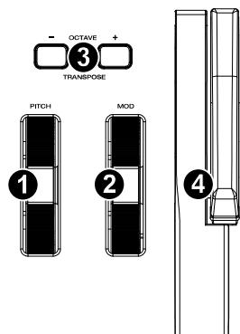
4. **Tastiera:** la tastiera sensibile alla velocità non è solo il metodo principale per inviare note On / Off e dati di velocità durante l'esecuzione, ma viene anche utilizzata per accedere alle funzioni di programmazione estese elencate lungo il bordo superiore.
