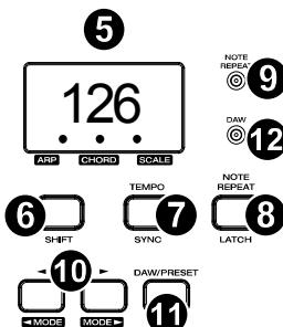
**11. DAW/PRESET :** lorsque ce bouton est enfoncé, il active la fonctionnalité Preset ou DAW du clavier sur le Fader, les boutons, le bouton et les pads.
