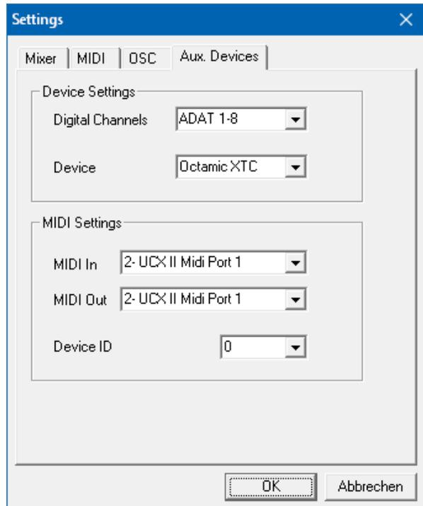
Bei der Nutzung mehrerer OctaMic XTC müssen diese unterschiedliche Device IDs besitzen (Konfiguration erfolgt im OctaMic XTC). Auch in *Aux Devices* lassen sich den 8-Kanal Blöcken verschiedene Device IDs zuweisen. Die Speicherung erfolgt sofort bei Auswahl einer Device ID. Die Prüfung der Zuweisungen erfolgt durch abwechselnde Anwahl der beiden 8-Kanal Blöcke.
