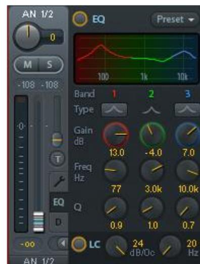
**Lo Cut.** Wird über den Button Lo Cut aktiviert. Die Flankensteilheit des Hochpasses ist einstellbar zwischen 6, 12, 18 und 24 dB pro Oktave. Die Grenzfrequenz (-3 dB) ist einstellbar zwischen 20 Hz und 500 Hz.
