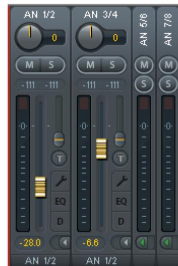
Das unterste Feld zeigt das aktuelle **Routingziel**. Per Mausklick öffnet sich das Routingfenster zur Auswahl eines Routingziels. Alle derzeit für diesen Kanal aktiven Routings sind mit vorangestellten Pfeilen markiert, der aktuelle erscheint in fetter Schrift.
