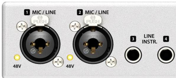
Über Eingang 3/4, **INST/LINE**, lässt sich per 6,3 mm Klinkenstecker sowohl ein symmetrisches Line-, als auch ein unsymmetrisches Instrumentensignal einspeisen.
