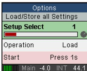
Das Fireface UCX II kann seinen aktuellen Zustand in 6 Speicherplätzen (Setups) ablegen und laden (SETUP/REV, Options, Load/Store all Settings). Damit ist das Fireface UCX II nach entsprechender Konfiguration Stand-Alone nutzbar, und ersetzt zahlreiche Geräte (siehe Kapitel 24).
