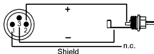
Mittels dieses Kabeladapters lassen sich auch Geräte mit koaxialer SPDIF-Schnittstelle an den AES-Ausgang des UCX II anschließen. Allerdings akzeptieren viele Consumergeräte mit Cinch-Eingängen (SPDIF) nur Signale mit dem Channel Status *Consumer*. Das beschriebene Adapterkabel wird in solchen Fällen nicht funktionieren.
