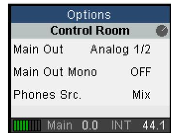
Taste SETUP/REV drücken. Das Menü *Options* erscheint. Der Cursor befindet sich in der zweiten Zeile und hat das Knopf-Symbol. Durch Drehen des Encoders wechselt man im Menü horizontal zwischen den Seiten *Clock*, *Hardware/Diagnosis*, *Load/Store all Settings* und *Control Room*. Nach Auswahl von *Clock* den Encoder drücken. Das Knopf-Symbol ändert sich in Doppelpfeile. Durch Drehen des Encoders bewegt sich der Cursor nun vertikal durch das Menü.
