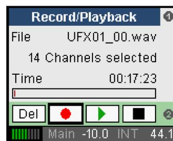
**Transport Bar.** Durch Drehen des Encoders bewegt sich der Cursor über *Del* (Delete), *Stop*, *Play/Pause* und *Record*. Die selektierte Funktion wird durch einen Druck auf den Encoder aktiviert. Bei Wiedergabe ändern sich Del / Record zu Previous File / Next File.
