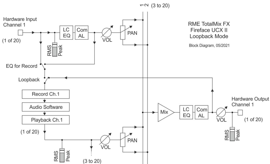
Da jeder der 10 Stereo-Hardwareausgänge zur Aufnahmesoftware geschaltet werden kann, und die jeweiligen Hardwareeingänge prinzipiell nicht verloren gehen, bietet TotalMix insgesamt eine unerreichte Flexibilität und Performance.
