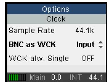
Herunterscrollen bis zu *BNC as WCK*. Encoder drücken so dass das Knopf-Symbol erscheint. Durch drehen die gewünschte Funktion *Input* oder *Output* auswählen. Menü durch zweimaliges drücken des SETUP/REV Tasters schnell verlassen. Das Menü wechselt aber nach 90 Sekunden ohne Eingabe auch automatisch zum Level Meter Bildschirm.
