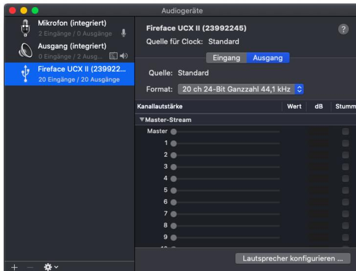
Bei Auswahl von 8 und 14 Kanälen kann eine Samplefrequenz bis zu 192 kHz genutzt werden. Unter iOS ist 192 kHz nicht möglich, weil es keine Auswahlmöglichkeit für das zweite und weitere *Alternate Settings* auf der Aufnahmeseite gibt. iOS und alle Apps nutzen immer das erste Setting, 20 Kanäle, welches dann sowohl Aufnahme als auch Wiedergabe auf 96 kHz begrenzt.
