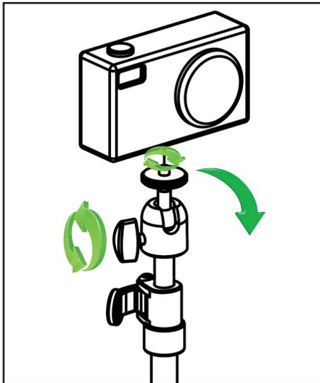
Equipment auf Stativ aufschrauben. Mit Hilfe der Rändelscheibe kann das aufgeschraubte Equipment gegebenenfalls arretiert werden.
