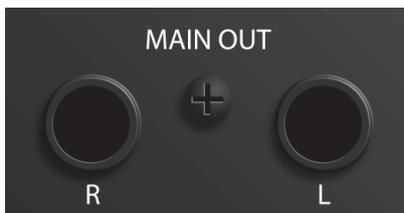
**Main-Ausgänge.** Das sind die Summenausgänge des Revelator io44. Der Ausgangspegel für die Main-Ausgänge wird über den Main-Pegelsteller auf der Gerätevorderseite eingestellt. Die Wiedergabe-Streams 1 und 2 werden auf diese Ausgänge geroutet.
