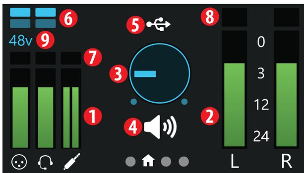
1. **Eingangspegelanzeigen.** Diese Pegelanzeigen stellen den Pegel an den analogen Eingängen Ihres Revelator io44 dar. Die rote Clip-Anzeige leuchtet, sobald der Pegel am Eingang  $-0,5$  dBFS erreicht. Ab diesem Pegel kommt es zu einer Übersteuerung der AD-Wandler mit hörbaren Verzerrungen. Verwenden Sie die Gain-Steuerung, um die Pegel unterhalb dieser Grenze zu halten.
