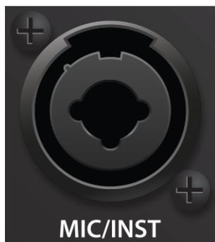
**Mic/Inst-Eingang.** Der Eingang für Kanal 1 Ihres Revelator io44 Interfaces ist als Combo-Buchse ausgeführt. An dieser praktischen Buchse können sowohl 6,35 mm TS-Klinkenkabel (für hochohmige Instrumentenquellen wie Gitarren und Bässe) als auch XLR-Kabel (für professionelle Mikrofone) angeschlossen werden. Der XMAX-L Solid State Mikrofon-Preamp des XLR-Anschlusses ist speziell für die Stromversorgung über den USB-Bus optimiert.
