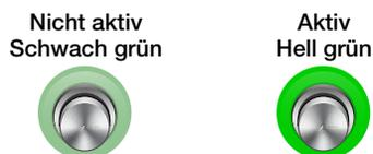
Abbildung 1: Die Fußtasterdioden A, B und C zeigen jeweils an, welcher Speicher aktiv ist
