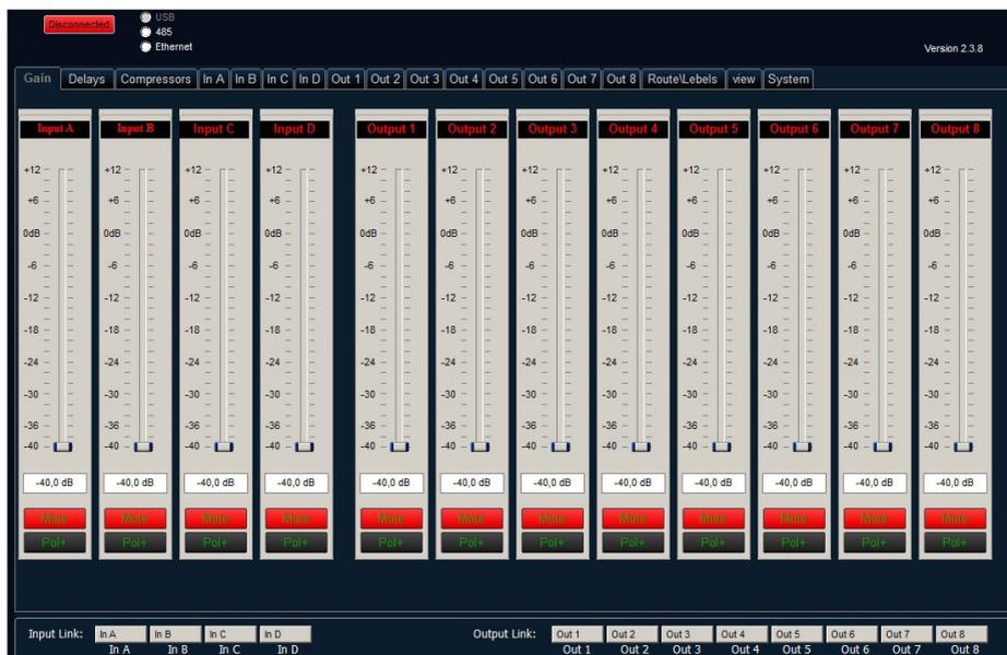
Nella finestra precedente è possibile impostare Gain, Polarity e Mute per tutti i canali INPUT e OUTPUT e, selezionare anche il tipo di parametri che si desidera modificare. Cliccando con il tasto sinistro del mouse in corrispondenza dell'opzione desiderata, verranno aperte le finestre relative ai gruppi di parametri. (Gain, Delays, Compressors, In A ÷ In D, Out 1 ÷ Out 8, Route/Labels, View, System).
