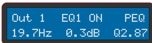
La seconda riga del display mostra i parametri FREQUENCY, GAIN e Q che possono essere modificati utilizzando rispettivamente l'encoder sinistro, centrale e destro. Se il tipo di filtro selezionato è uno tra LS6, LS12, HS6 o HS12, è possibile impostare solo i parametri FREQUENCY e GAIN. Se il tipo di filtro selezionato è APF, non è possibile impostare il parametro GAIN.
