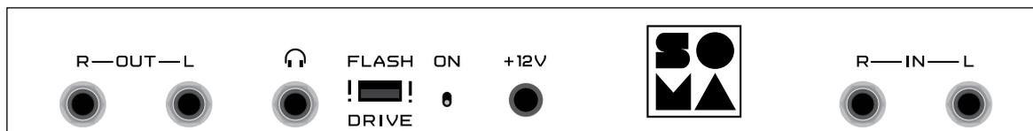
**R-OUT-L** Symmetrischer Stereo-Ausgang. Wenn nur eine der beiden Buchsen belegt ist, wird automatisch ein Mono-Mix erzeugt, um die gesamte klangliche Bandbreite des COSMOS zu erhalten.
