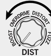
Drehen Sie den Regler langsam, um die Parameter des aktuellen Effekts zu editieren. Drehen Sie ihn auf den Mindestwert, um den Effekt zu umgehen.
