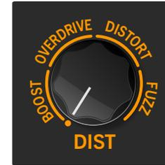
Drehen Sie einen Effektregler komplett gegen den Uhrzeigersinn, um diesen Block zu umgehen
