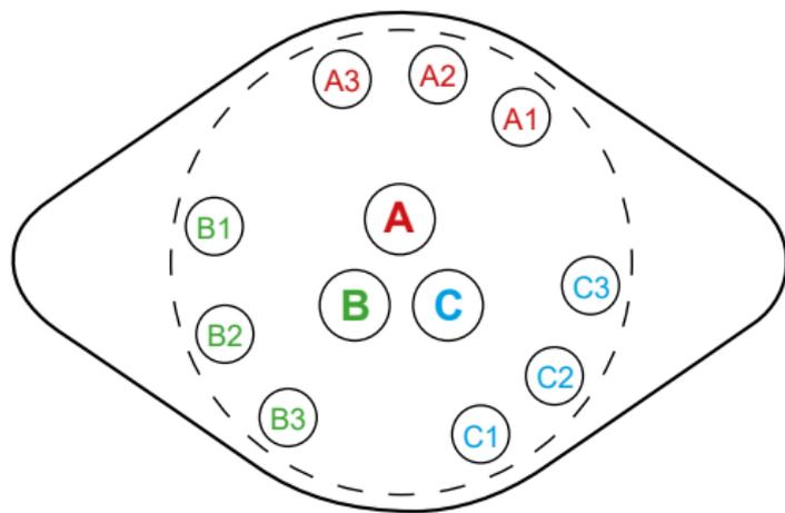
Die Anschlüsse sind nicht beschriftet. Die Kontakte der Position 1 können aber leicht ermittelt werden, indem man den Schalter ganz nach links dreht. Dann ist von der Seite erkennbar, auf welchen Kontakten die Schleifer liegen.
