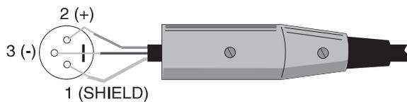
Abb 3. Symmetrische Belegung des XLR Eingangsanschlusses.
