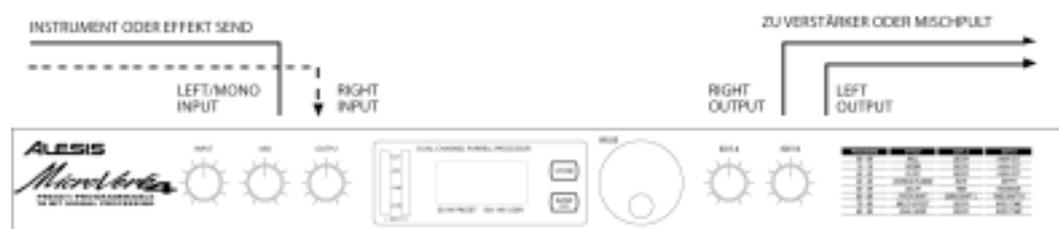
Bei der Verbindung mit den Aux Sends>Returns eines Mixers sollten Sie den Ausganges [MIX] so einstellen, dass das MicroVerb 4 nur das bearbeitete Signal ausgibt.
