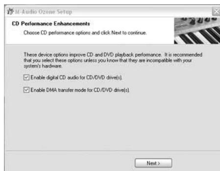
7. Anschließend wird das M-Audio-Setup-Fenster angezeigt. Vergewissern Sie sich, dass die Kontrollkästchen "Enable Digital CD" und "Enable DMA Transfer Mode" markiert sind und klicken Sie auf "Weiter".
