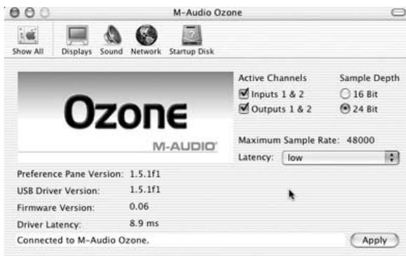
**Active Channels:** Aktivieren und deaktivieren Sie ein Kanalpaar, indem Sie ein Häkchen in das entsprechende Kontrollkästchen setzen. Nach der Erstinstallation des Control Panels sind sowohl die Eingänge 1 und 2, als auch die beiden Ausgänge standardmäßig “aktiviert”.
