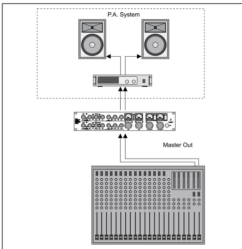
Abb. 3.1: Der TUBE COMPOSER als Schutzeinrichtung passiver Anlagen
