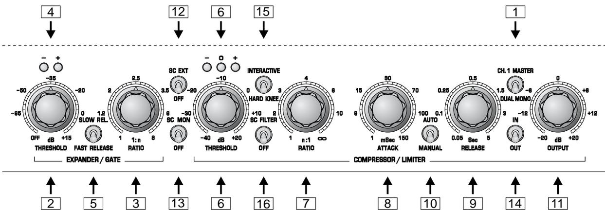
Abb. 1.2: Bedienelemente der Expander/Gate- und Kompressor/Limitersektionen
