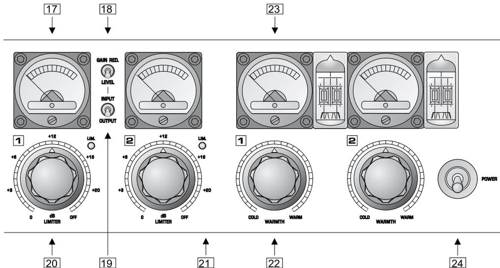
Abb. 1.3: Bedienelemente der Peak Limiter- und Röhrensektionen
