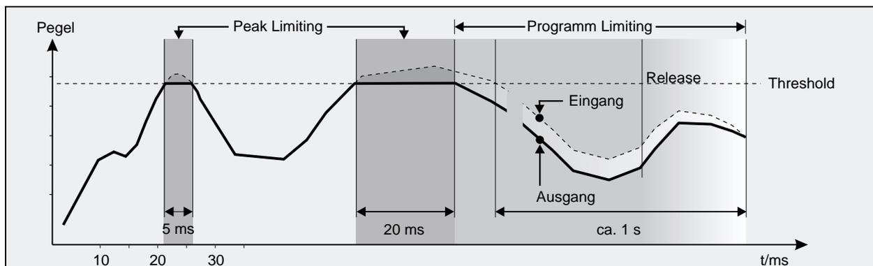
Abb. 2.3: IGC-Charakteristik der Limiter-Sektion
