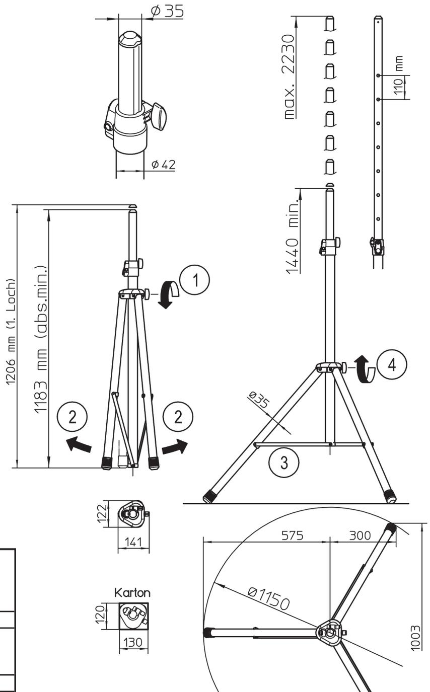
\* Bei zentraler Belastung, auf waagerechter Fläche und ohne Seitenkräfte (Wind, Stöße etc.)
