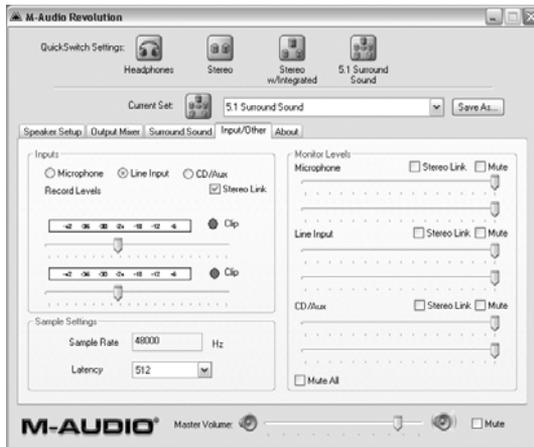
Über die Input/Other-Karte können Sie den Eingangspegel (Aufnahme und Monitor) einstellen. Außerdem zeigt es Ihnen die aktuelle Samplefrequenz der Revolution 5.1 an und gibt Ihnen die Möglichkeit, die Buffergröße für die Latenzzeit einzustellen! also gives you a display of the current sampling frequency of the Revolution 5.1 and allows you to set the Latency buffer. Die genannten Einstellungen sind nur relevant, wenn Sie Revolution 5.1 für Ihre Audioaufnahmen einsetzen wollen.
