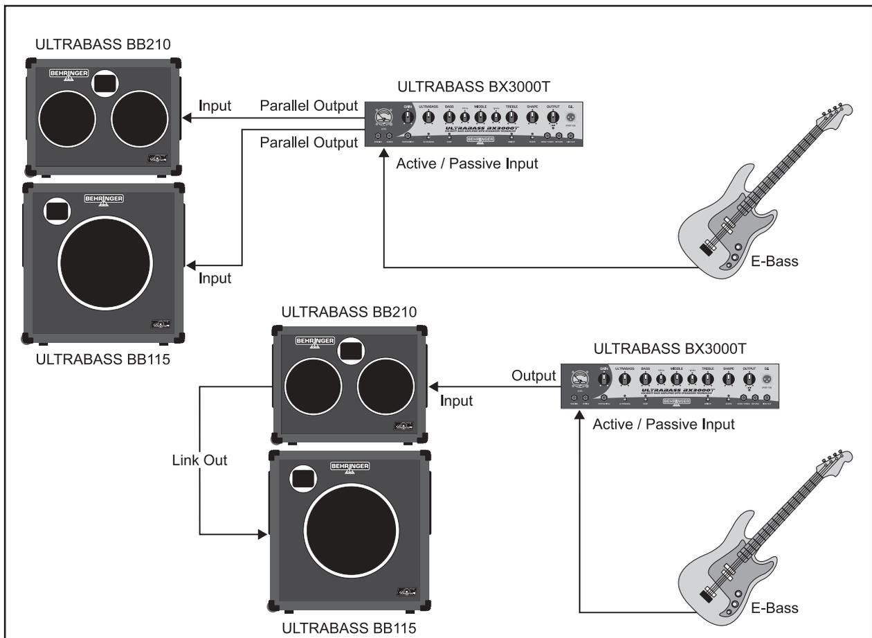
Abb. 3.2: Erweitertes Mono-Setup mit verschiedenen Anschlussoptionen für Lautsprecher
