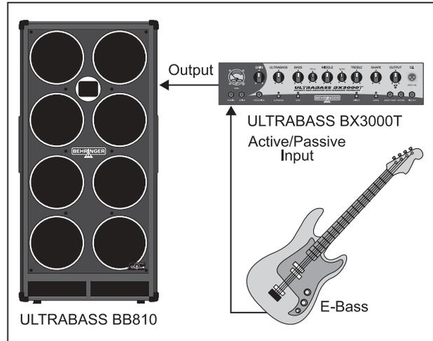
Abb. 3.3: Setup mit der BB810 und dem BX3000T
