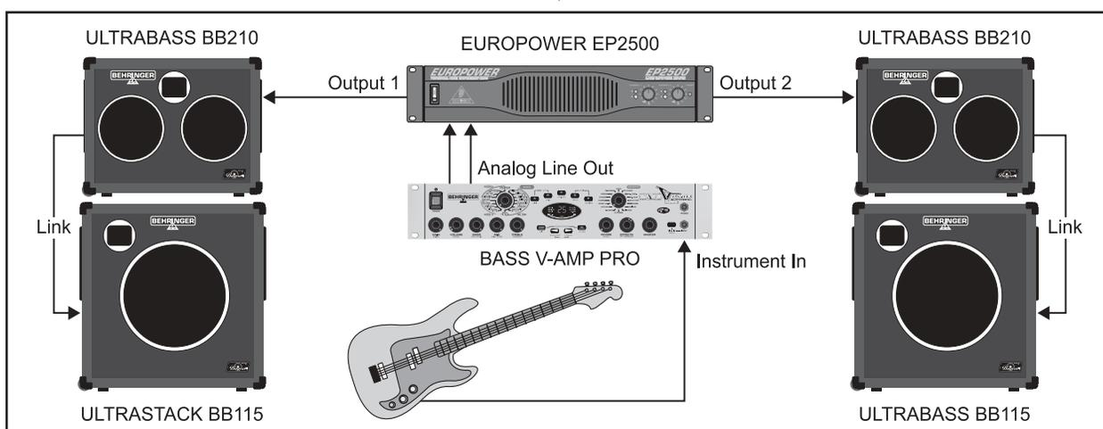
Abb. 3.4: Erweiterte Stereo-Konfiguration
