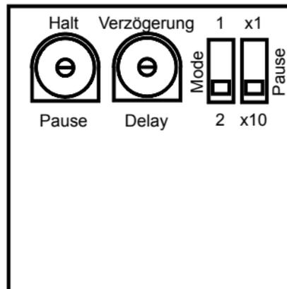
El tiempo de permanencia en la estación se configura mediante el interruptor „Pausa“ y el regulador de ajuste „Parada“ de la platina.
