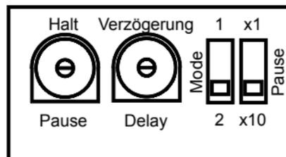
Le réglage du temps d'arrêt à la gare se fait par le commutateur «Pause» et avec le bouton de réglage «Pause» de la carte de circuits.
