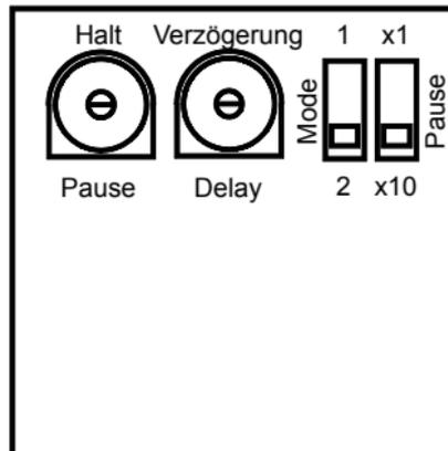
De oponthoudtijd in het station wordt met de schakelaar “Pause” en de instelregelaar “Halt” op de printplaat ingesteld.
