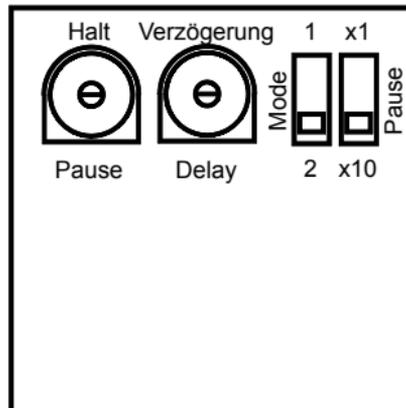
Die Aufenthaltsdauer im Bahnhof wird über den Schalter „Pause“ und den Einstellregler „Halt“ auf der Platine eingestellt.
