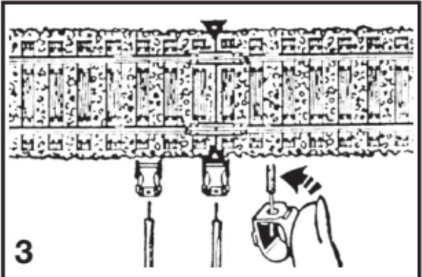
Posez les bornes avec les repères aux joints de rails. Appuyez sur la voie jusqu'à encliquetage.
