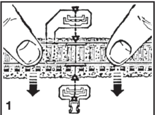
Markierungsspitzen der Klemmen am Schienenstoß anlegen. Auf Gleis drücken bis Klemmen einrasten.
