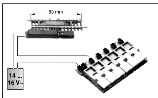
(DE) Für die elektrische Zuleitung des Entkupplungsgleises ist das beiliegende Anschlusskabel mit den Kabelschuhen zu verwenden.
