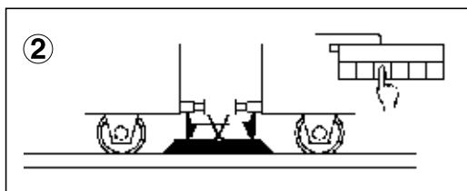
(DE) Taste am Tastenpult niederdrücken – Kupplungen öffnen sich.
