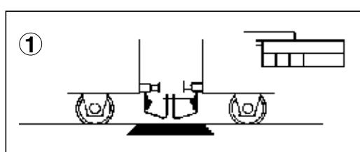
(DE) Zug oder Rangiereinheit so zum Stehen bringen, dass sich die Kupplungen der zu entkuppelnden Fahrzeuge über der Entkupplungsbohle befinden.
