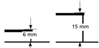
Für unterschiedliche Gleissysteme liegen zwei verschiedene Bahnsteighöhen bei.
