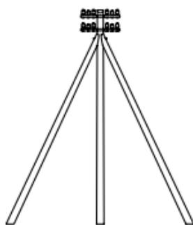
Für Stützpfiler bei längeren Geraden
