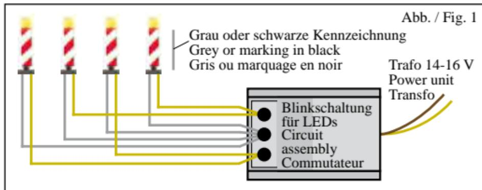
Da sich beim Dauerbetrieb Wärme entwickelt, sollte sich im Bereich der Schaltung eine geringe Luftzirkulation ergeben. Die Schaltung sollte daher nicht in einem luftdichten Gehäuse eingebaut werden.
